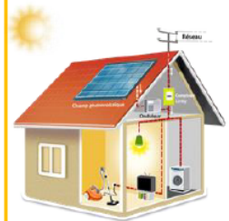
Schéma en autoconsommation. Un seul compteur pour la production et la consommation. Le compteur compte la production que vous injectez sur le réseau et la consommation que vous soutirez du réseau.
