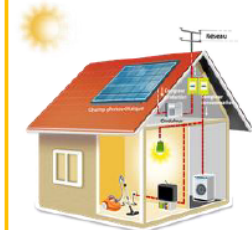
Schéma en vente totale. Un compteur pour la production que vous vendez intégralement, et un compteur pour votre consommation.
