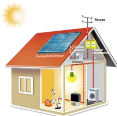
Schéma en vente totale. Un compteur pour la production que vous vendez intégralement, et un compteur pour votre consommation.
