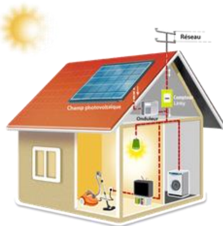
Schéma en autoconsommation. Un seul compteur pour la production et la consommation. Le compteur compte la production que vous injectez sur le réseau et la consommation que vous soutirez du réseau.
